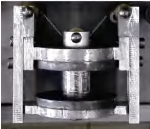
图1 柔性关节机械结构刚体模型
