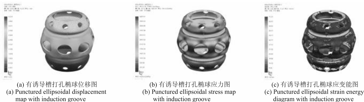
图9 有诱导槽打孔椭球的仿真结果
