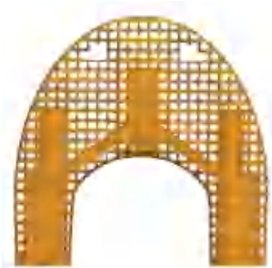
图 6 U 型动力救生装置内部栅格结构
