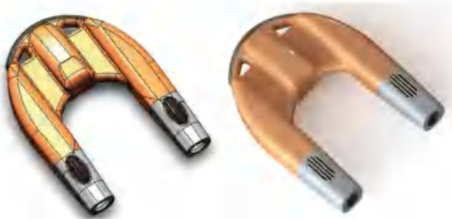
图 12 U 型动力救生装置优化设计结构外形图与效果图
