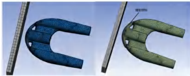
(a) 不包覆橡胶 (b) 头部包覆橡胶
